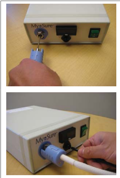
AFBEELDING 6. SLUIT DE AANDRIJFKABEL EN HET VOETPEDAAL AAN OP DE MYOSURE® REGELEENHEID
